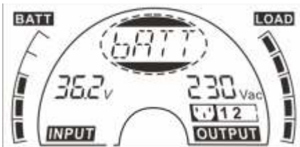
Режим работы от батарей
